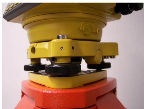
Detalle sobre la plataforma nivelante
