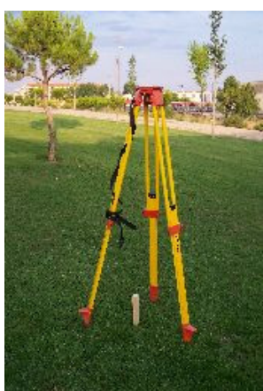
Trípode excesivamente cerrado
