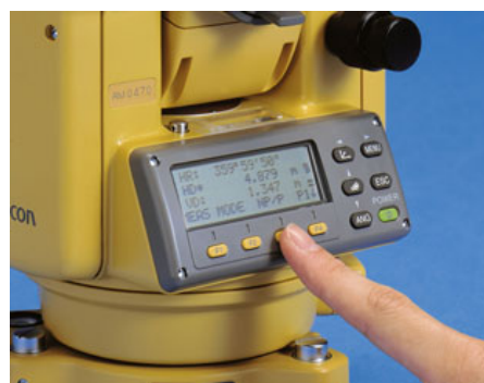
Estación Total Topcon. Detalle de la pantalla
