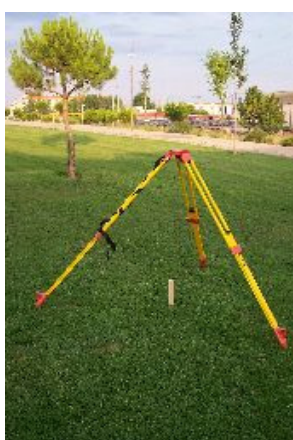
Trípode excesivamente abierto
